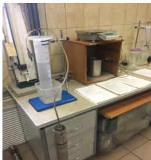
Рис. 3. Определение объема выделяющегося газа при атмосферном давлении в лаборатории ЦУХЛ
