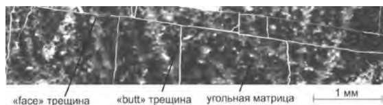
Рис. 3. Трещиноватость угля марки Ж (шахта им. С.Д. Тихова, горизонт 200 м) (трещины выделены белым цветом)
