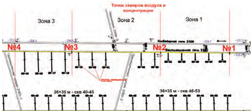
Рис. 4. Расположения точек замера скоростей воздуха и концентраций метана на объекте исследований фактора дегазации угольного пласта подготовительной выработкой на выемочном участке 24—60
