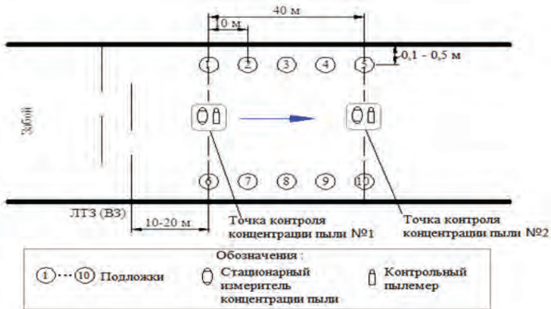
Рис. 4. Схема размещения подложек и приборов контроля запыленности рудничной атмосферы в пяти точках вдоль обоих бортов горной выработки
