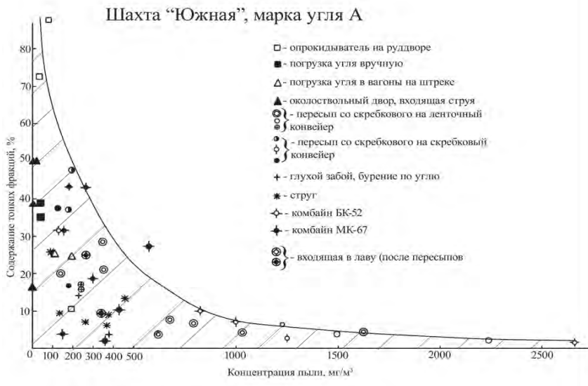
Рис. 2. Содержание тонких фракций в витающей пыли в угольной шахте в зависимости от концентрации пыли всех размеров по общей массе [3]
