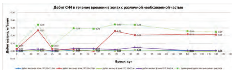
Рис. 3. Динамика изменения дебита метана из скважин в вентиляционной печи 24—60 с различной эффективной длиной во времени
