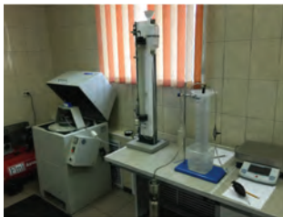
Рис. 4. Измерение объёмов газа, выделяющегося при измельчении пробы угля в герметичной мельнице
