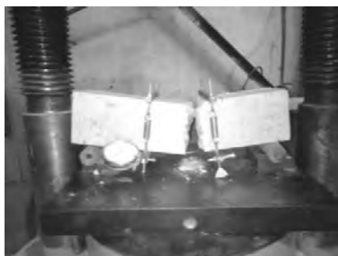
Рис. 3. Результаты испытания образца-кубика на сжатие
