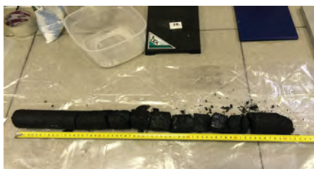
Рис. 5, а Угольный керн из вентиляционной печи 2457
